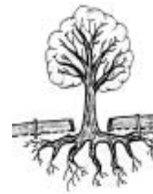
Formar un pozo alrededor del tronco, sin enterrar el cuello. Colocar tubos perforados (para aireación, riego y abonado) y cubrir con 15-20 cm de grava.
